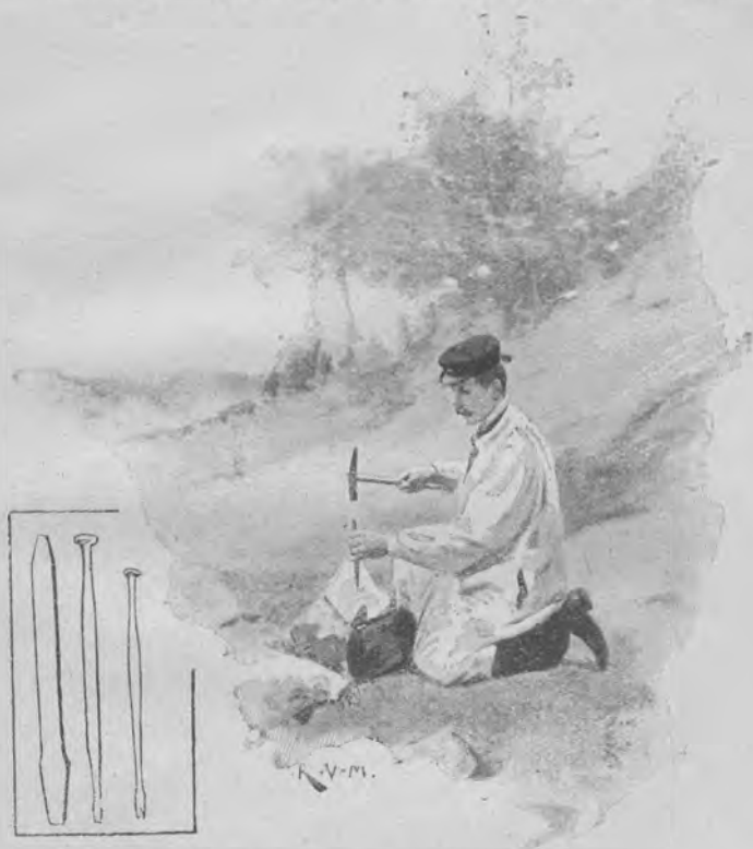
LE CISEAU A FROID ET SES DIFFÉRENTES FORMES.
